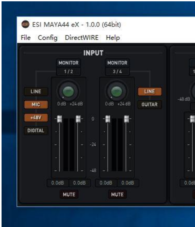
图 15: 话筒和线路输入的切换直接在驱动控制界面上调节, 48V 幻相供电也是在这里打开
