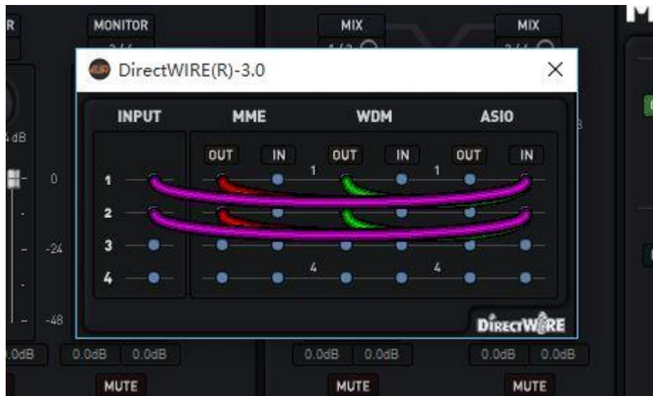
图 14: 从声卡输入、电脑本身发出的声音都连接到了 ASIO 的 IN，这些声音都可以被录下来了，比如你在网页上播放一个音乐，然后打开 Cubase 录下来就可以了。
